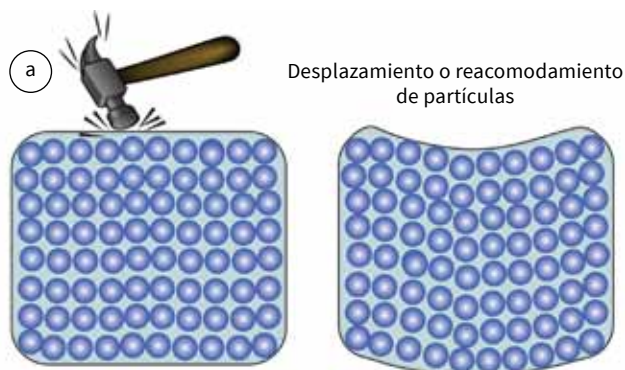
a) Deformación de un metal por una fuerza externa b) Representación de un sólido cristalino c) Dilatación de las uniones de las partículas. Al aumentar la temperatura, las partículas adquieren energía y aumentan las distancias entre ellas
