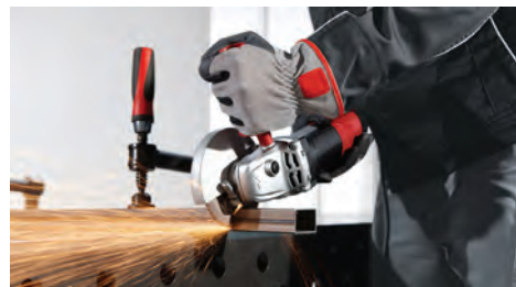
La energía cinética del disco permite el corte del material
