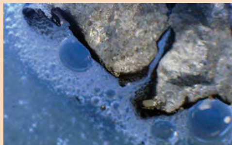
La imagen muestra la reacción de la lámina de cinc metálico con ácido clorhídrico, también llamado ácido muriático. El gas desprendido en forma de burbujas es hidrógeno
