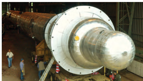
Un reactor químico es un equipo en cuyo interior tiene lugar una reacción química, estando este diseñado para maximizar la conversión y selectividad de la misma con el menor coste posible. En la imagen, se muestra un reactor químico de YPF para la Hidrodesulfuración de gasoil
