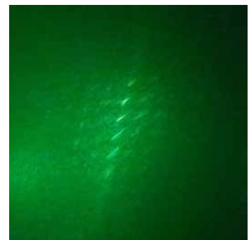
Imagen obtenida al pasar un láser verde a través de una pequeña pluma de paloma
